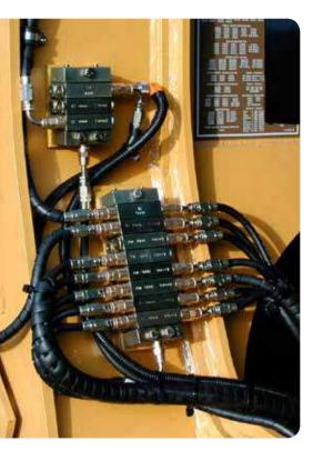
En los sistemas de lubricación automática progresivos, una bomba de pistón suministra, a través de la línea principal, una cantidad definida de lubricante al dispositivo dosificador que actúa en cada salida. Los sistemas SKF ProFlex y Lincoln Quicklub están diseñados para aplicaciones específicas y pueden configurarse para satisfacer los requisitos exclusivos de
