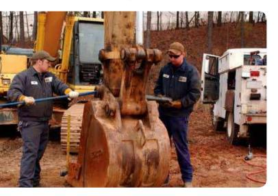
No lubricar todos los puntos de lubricación, en cada máquina y en cada turno, puede tener un efecto negativo sobre las tareas programadas, los costos de mantenimiento y el cumplimiento de horarios. Cuando se deja que el agua, la suciedad, la arena y el polvo de roca penetren en los componentes, se forma un "compuesto abrasivo" que puede reducir sustancialmente la vida útil del rodamiento. Esto provoca paradas no planificadas y reducción de la productividad.
